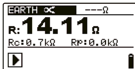
Figura 5.6: Ejemplo de resultado de la medición de la resistencia de tierra selectiva
