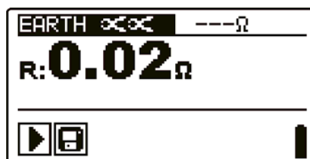
Figura 5.8: Ejemplo de resultado de la medición de la resistencia de tierra sin contacto
