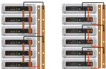
Figura 5-1. Diagrama esquemático de la conexión del cable de alimentación
