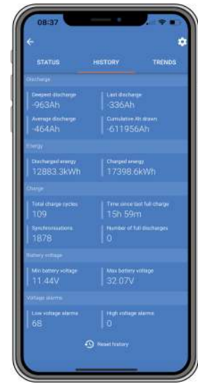
La aplicación VictronConnect mostrando el historial de un monitor de baterías
