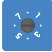
Interruptor giratorio en posición 2
