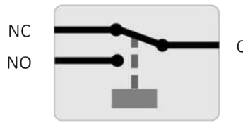
Funcionamiento interno del relé programable
