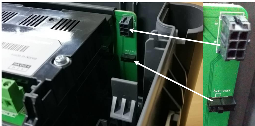
Figura 18. Interruptor de encendido/apagado y conector de la batería
