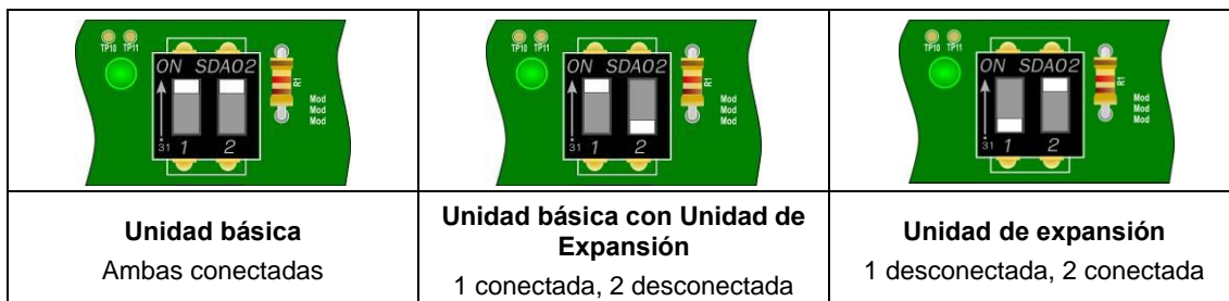
Figura 12. Configuración del interruptor DIP del panel posterior
