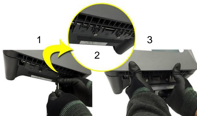
Figura 9. Desatornillado de los dos tornillos de seguridad y apertura de la caja
